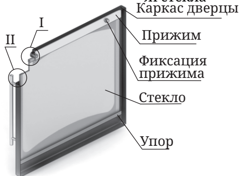
Рисунок 14. Ремонт светорозрачного экрана дверцы модификации «Витра»
